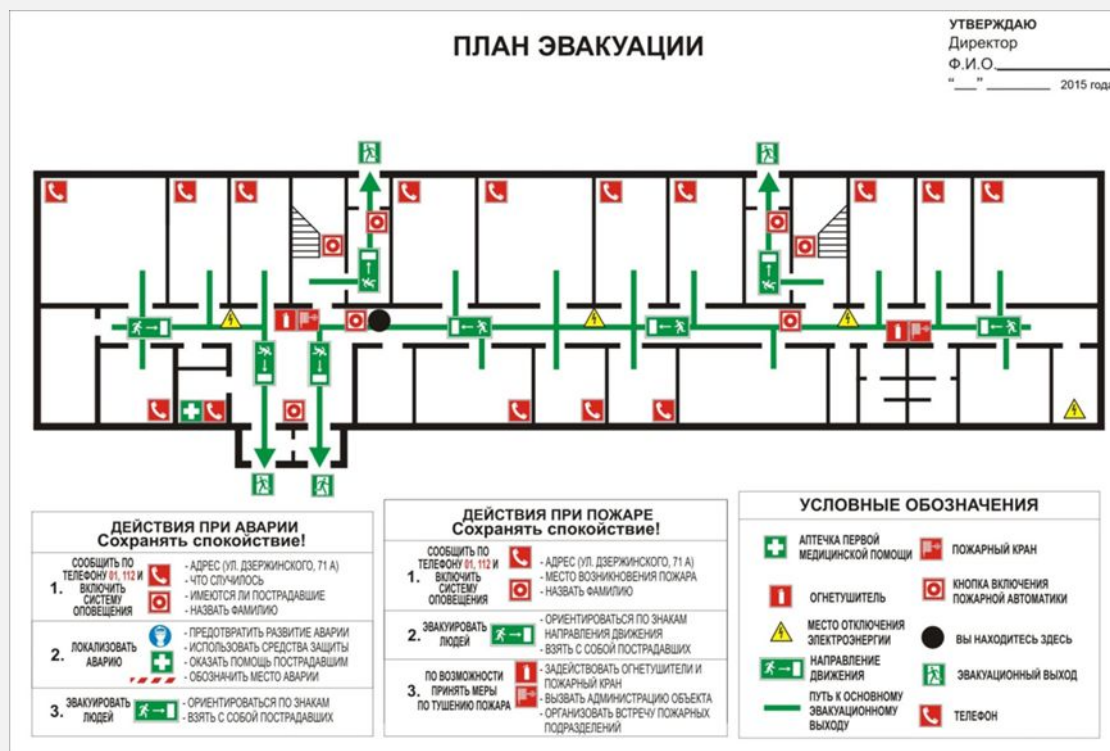
Рисунок 1. Схема аварийных проходов и выходов (схема эвакуации)
