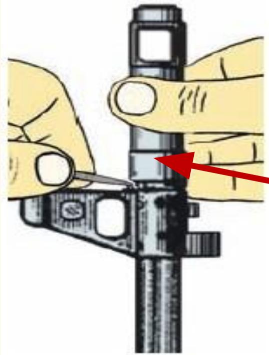
4) **Отделить дульный тормоз-компенсатор.** Свернуть дульный тормоз-компенсатор с резьбового выступа основания мушки, вращая его против хода часовой стрелки. В случае чрезмерно тугого вращения дульного тормоза-компенсатора допускается отворачивать его с помощью выколотки (шомпола), вставленной в окна дульного тормоза-компенсатора.
