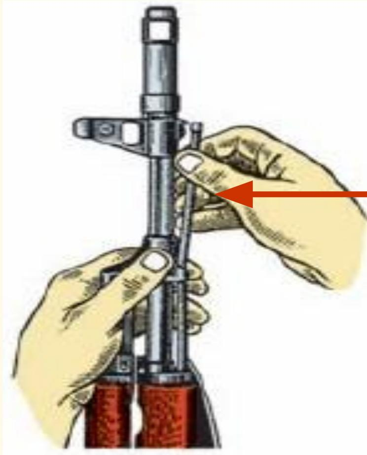
**3) Отделить шомпол. Оттянуть конец шомпола от ствола так, чтобы его головка вышла из-под упора на основании мушки и вынуть шомпол.**
