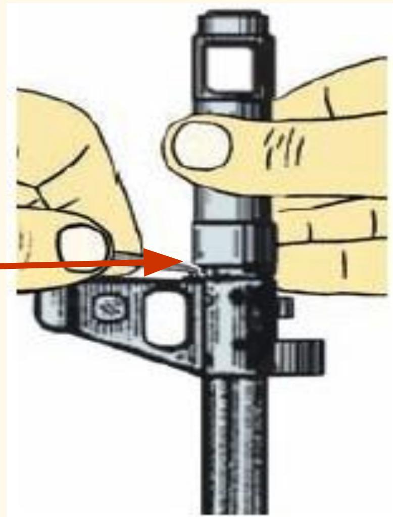
5) **Отделить крышку ствольной коробки.**левой рукой обхватить шейку приклада, большим пальцем этой руки нажать на выступ направляющего стержня возвратного механизма, правой рукой приподнять вверх заднюю ой рукой часть крышки ствольной коробки и отделить крышку.
