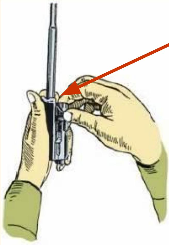
8) **Отделить затвор от затворной рамы. Взять затворную раму в левую руку затвором кверху правой рукой отвести затвор назад, повернуть его так, чтобы ведущий выступ затвора вышел из фигурного выреза затворной рамы, и вывести затвор вперёд.**
