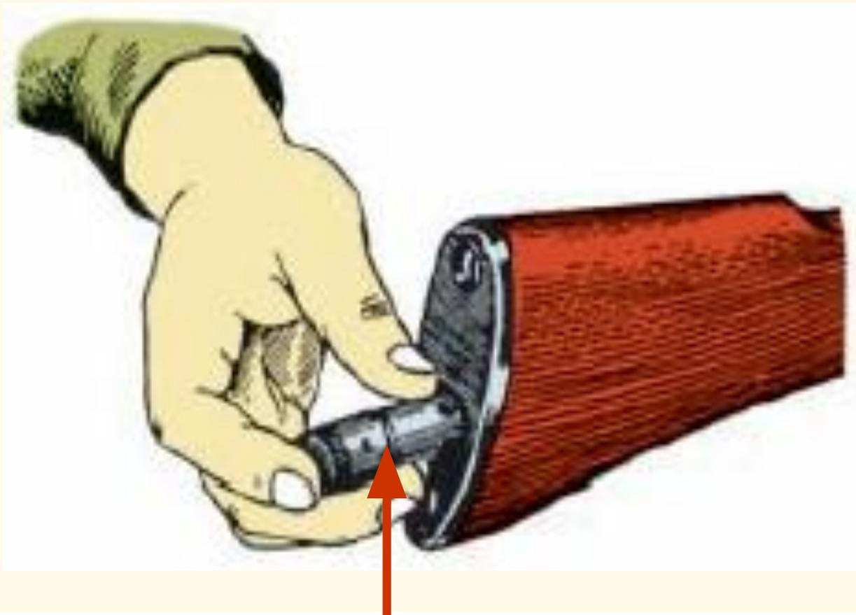
2) Вынуть пенал принадлежности из гнезда приклада. Утопить пальцем правой руки крышку гнезда так, чтобы пенал под действием пружины вышел из гнезда; раскрыть пенал и вынуть из него протирку, ёршик, отвёртку и выколотку.
