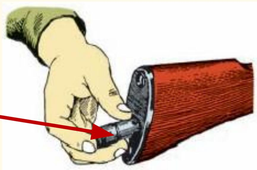
3) **Отделить шомпол.** Оттянуть конец шомпола от ствола так, чтобы его головка вышла из-под упора на основании мушки и вынуть шомпол.
