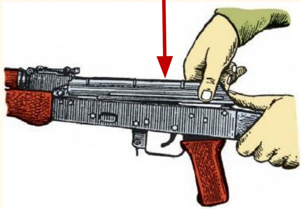
6) **Отделить возвратный механизм.** Удерживая автомат левой рукой за шейку приклада, правой рукой подать вперёд направляющий стержень возвратного механизма до выхода его пятки из продольного паза ствольной коробки; приподнять задний конец направляющего стержня и извлечь возвратный механизм из канала затворной рамы.
