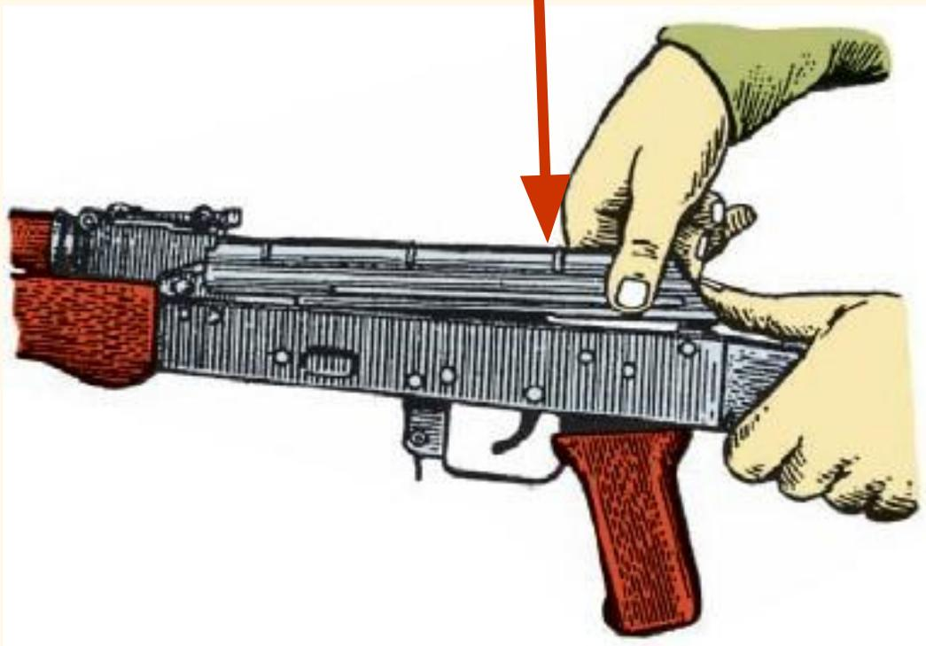
**б) Отделить возвратный механизм.** Удерживая автомат левой рукой за шейку приклада, правой рукой подать вперёд направляющий стержень возвратного механизма до выхода его пятки из продольного паза ствольной коробки; приподнять задний конец направляющего стержня и извлечь возвратный механизм из канала затворной рамы.
