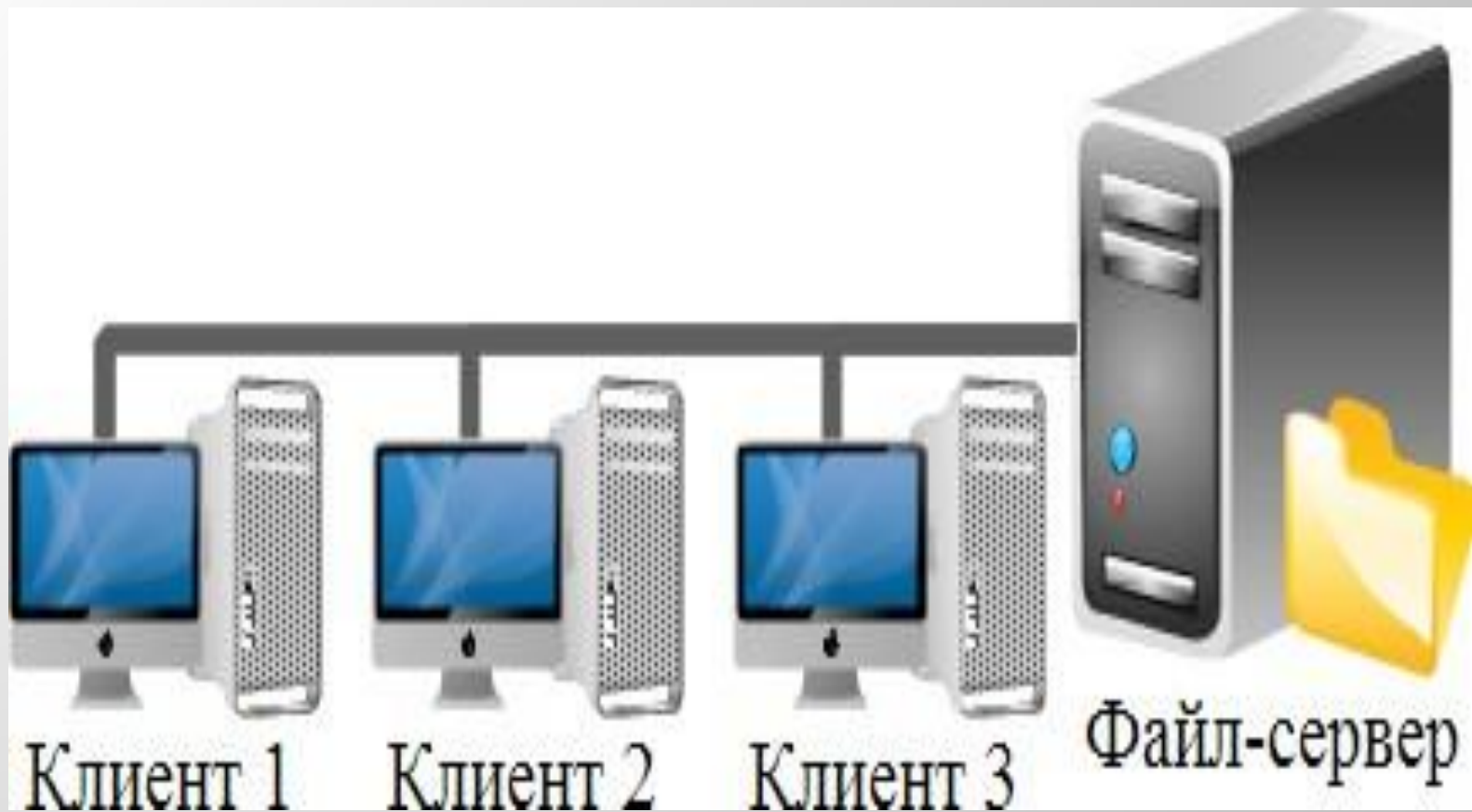
Рисунок 2 - Представление файл-серверной архитектуры
