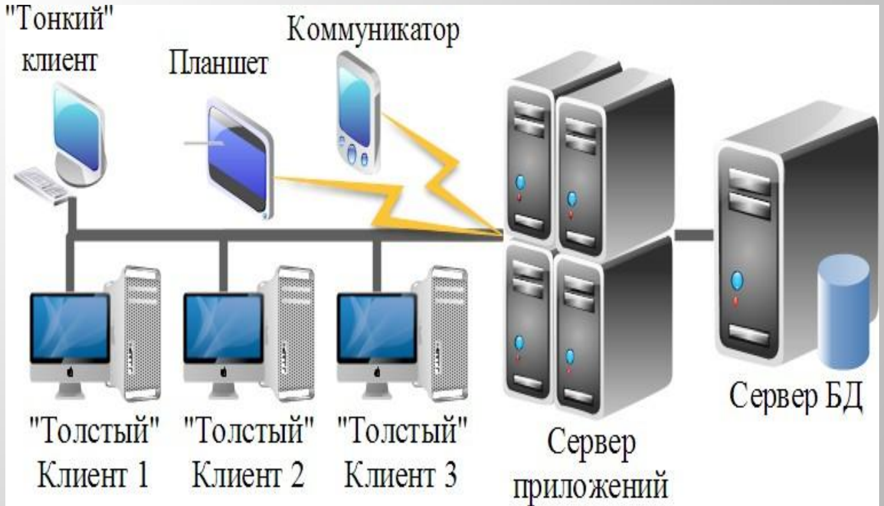
Рисунок 4 - Многозвенная клиент-серверная архитектура
