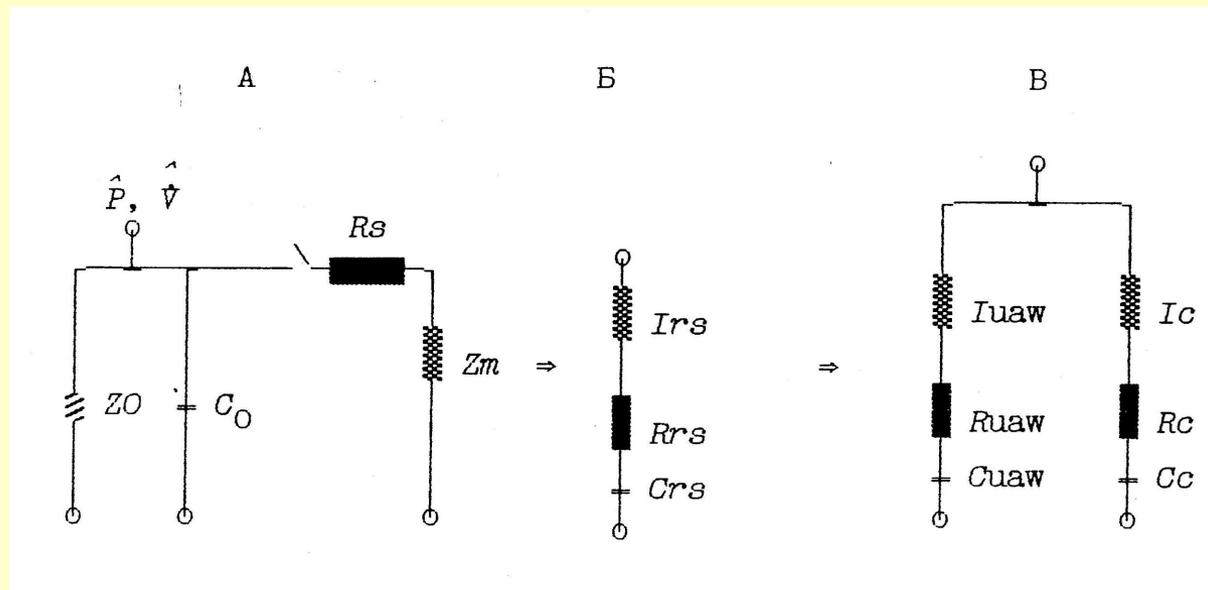
Электромеханические аналогии: А- модель прибора,  $\hat{P}, \hat{V}$  переменные давление и поток;  $Z_m$  – измеряемый импеданс,  $I_{rs}, R_{rs}, C_{rs}, I_c, R_c, C_c; I_{uaw}, R_{uaw}, C_{uaw}$  – инерционность  $I$ , сопротивление  $R$ , растяжимость  $C$  дыхательного тракта без коррекции и с коррекцией; верхних дыхательных путей.
