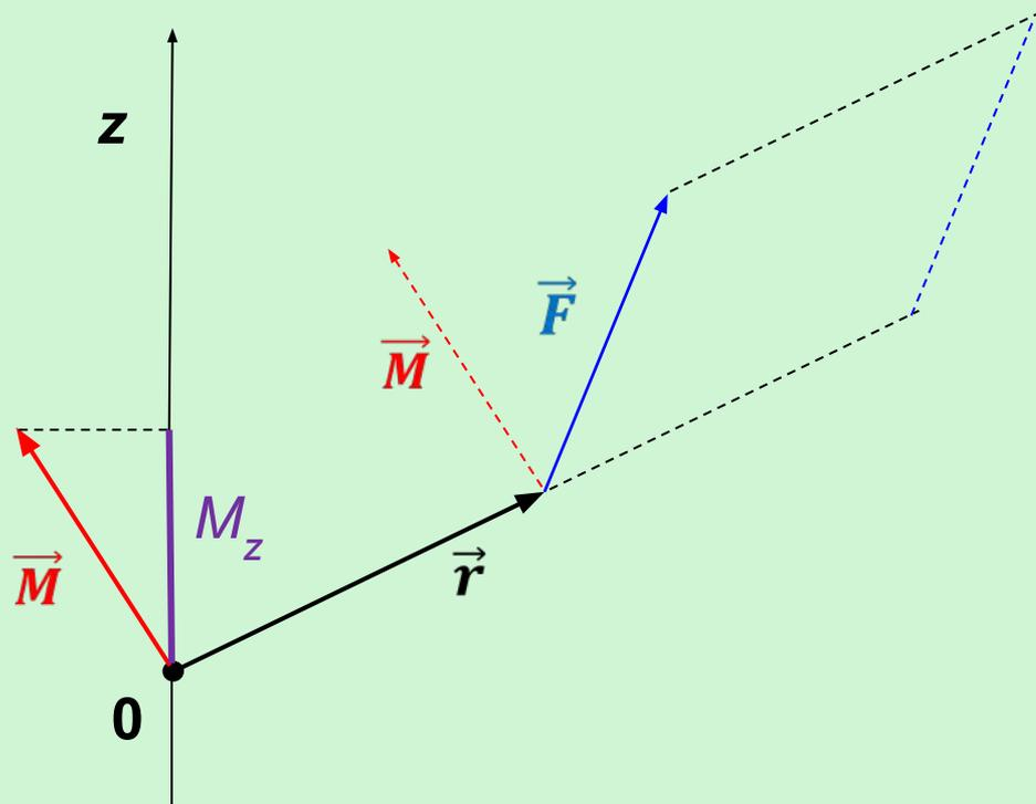
**Момент силы относительно неподвижной оси** — скалярная величина, равная проекции на эту ось вектора  $M$  относительно произвольной точки данной оси.
