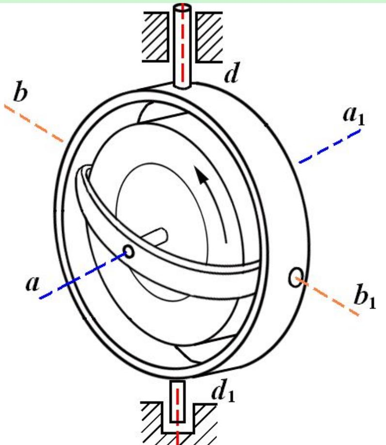
Дискообразное тело – *гироскоп* закреплено на оси  $aa_1$  – *ось гироскопа*, которая может вращаться вокруг перпендикулярной ей горизонтальной оси  $bb_1$ , которая, в свою очередь, может поворачиваться вокруг вертикальной оси  $dd_1$ .
