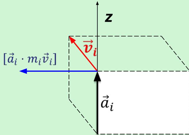
$$|[\vec{a}_i \cdot m_i \vec{v}_i]|_z = 0 \text{ т. к. } [\vec{a}_i \cdot m_i \vec{v}_i] \perp z.$$
