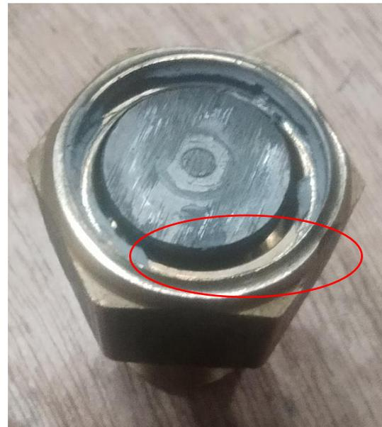
**Герметик (клей) нанесен на стыкуемые детали неравномерно, где то есть, где то отсутствует.**
