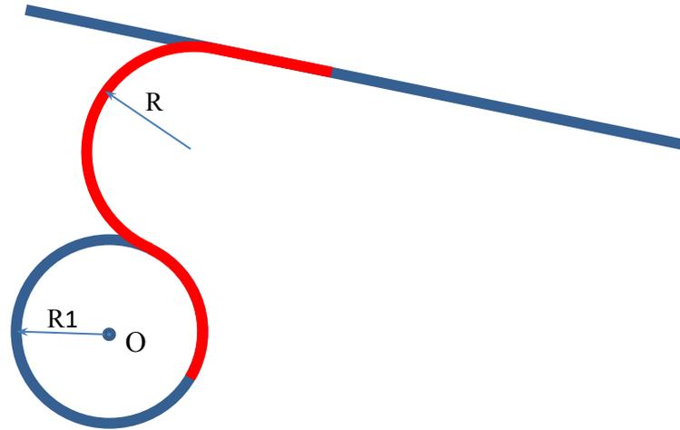
1. Из центра  $O$  провести окружность радиусом равным сумме радиусов данной окружности и окружности сопряжения  $R$
