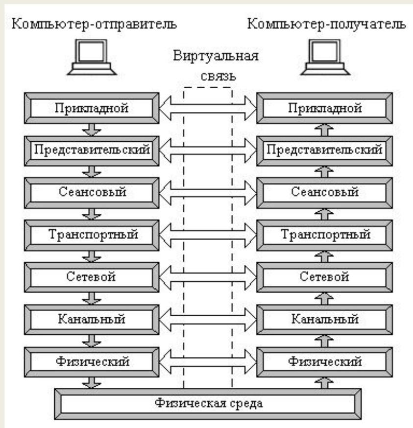
Каждый уровень компьютера-отправителя взаимодействует с таким же уровнем компьютера-получателя, как будто он связан напрямую. Такая связь называется логической или виртуальной связью.
