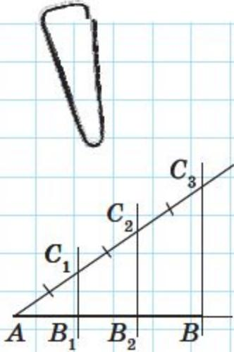
Рис. 48. Деление отрезка на равные части
