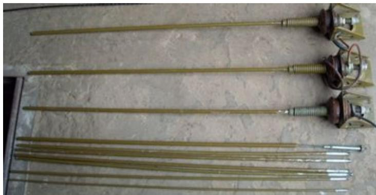
Антенны штыревые могут быть оборудованы механизмами подъема. Механизмы подъема штыревых антенн предназначены для изменения положения штыревых антенн. Они представляют собой электромеханические устройства, с помощью которых антенны могут быть установлены в наклонное, вертикальное или транспортное положение. Управление положением штыревых антенн осуществляется со щита управления, расположенного в кабине водителя.
