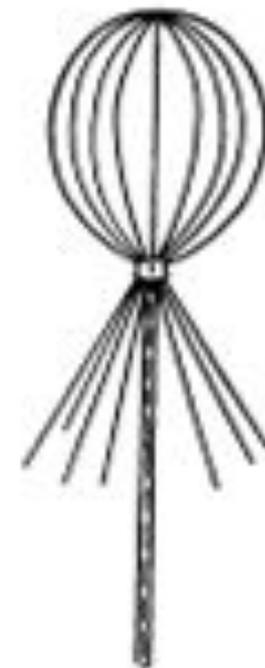
ШДА состоит из центрального стержня длиной 2655 мм, восьми стержней – вибраторов диаметром 6 мм, расположенных вокруг центрального стержня и восьми противовесов длиной 2 м каждый. Развертывание антенны производится на вершине телескопической мачты высотой 16 м. В транспортном положении антенна размещается в кожухе на крыше КШМ.
