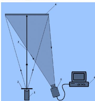
Схема экспериментальной установки. 1 – постоянный полупроводниковый лазер; 2 – предметное стекло с образцом суспензии; 3 – лазерный луч; 4 – экран, для наблюдения за картинами рассеяния; 5 – видеокамера; 6 – компьютерное электрооборудование (КОЭ)
