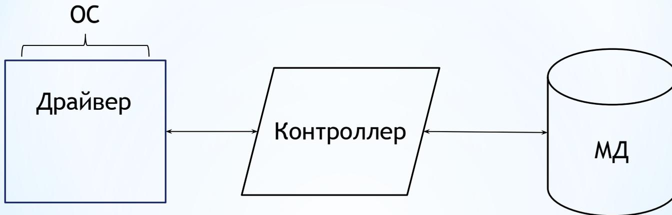
Связь с МД осуществляется через дисковый контроллер (электронная плата, присоединённая к шине периферийных устройств). Контроллер управляет операциями низкого уровня (пересылка данных, чтение/запись, ошибки).
