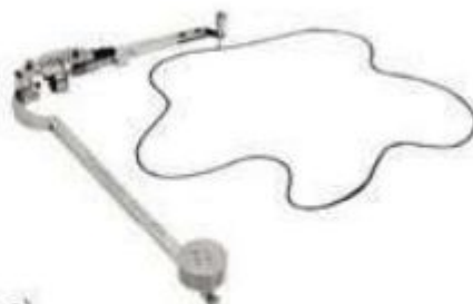
15 а, ә-сурет. Картографиялық құралдар: а) күрециметр ; ә) планиметр
