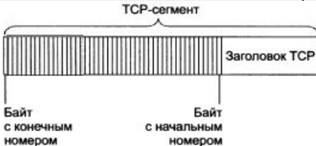
Рис. 16.15. Нумерация байтов в TCP-сегменте
