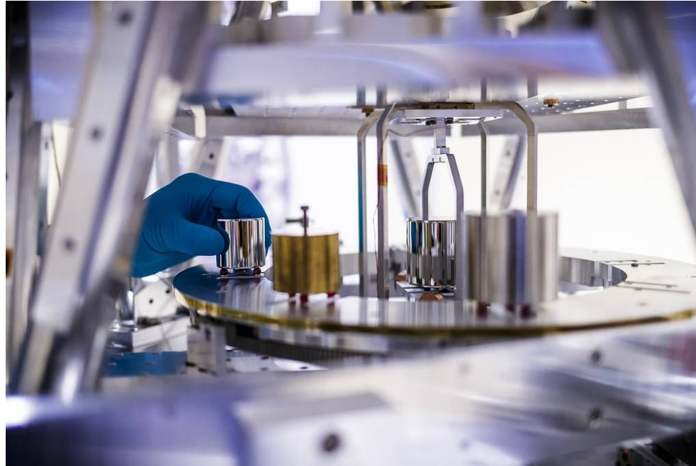
Изготовление копии эталонного килограмма
