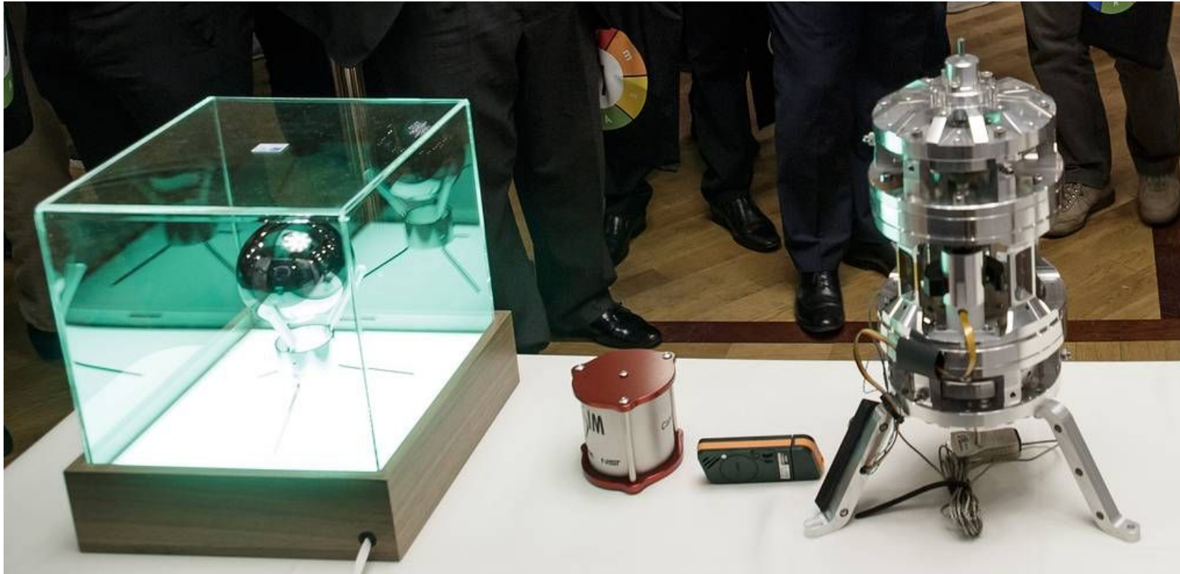
Устройство "баланс Киббла" для измерения электрического тока
