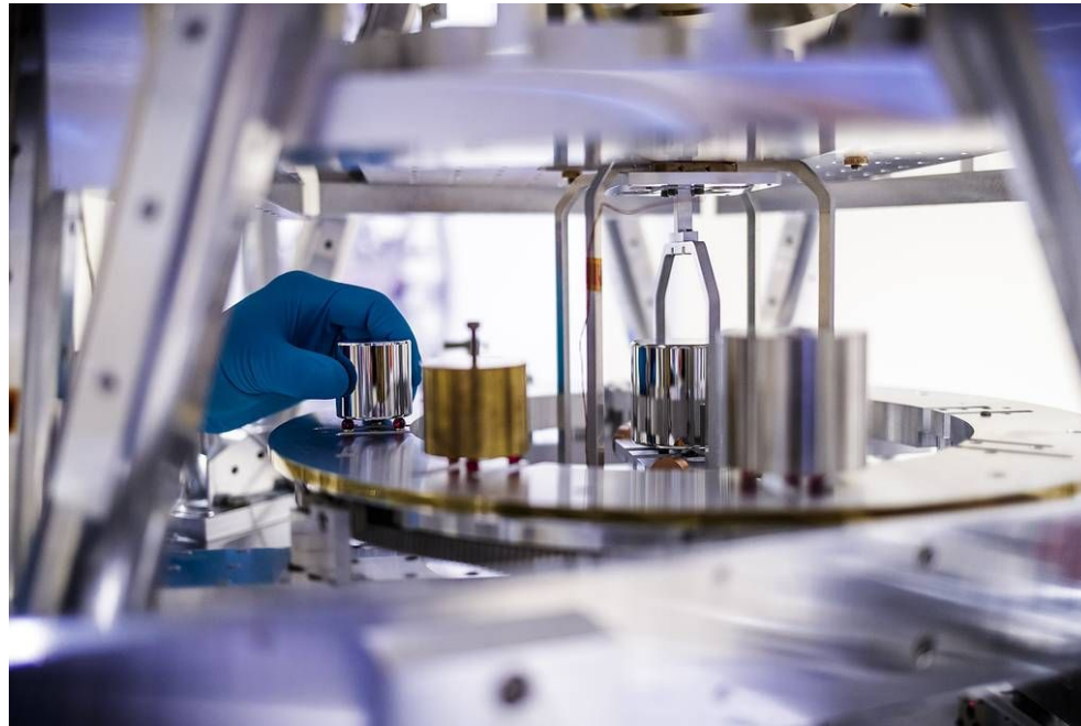
Изготовление копии эталонного килограмма
