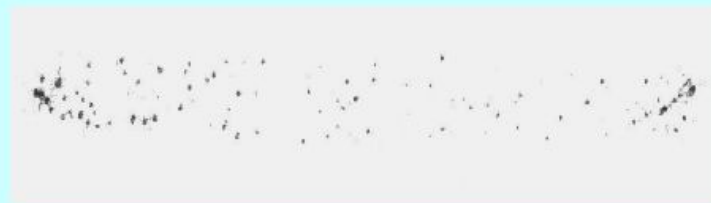
Отпечаток с поверхности лопатки, подвергнутой каплеударной эрозии, x 30
