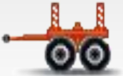
**Прицеп-ропуск трубоплетевозный** предназначен для перевозки в составе автопоезда труб и плетей по всем видам дорог и вне дорог общей сети. **Трубовозный прицеп-ропуск** может быть оборудован телескопическим дышлом.
