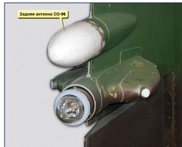
Размещение антенн СО-96 на борту СУ-25СМ
