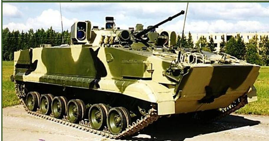
Машина предназначена для разведки на поле боя и артиллерийской разведки в составе подразделений сухопутных войск и отрядов морского десанта днем и ночью в любое время года и при любой погоде, включая условия ограниченной видимости. Специальный комплекс приборов разведки, установленных на машине, позволяет экипажу производить поиск, обнаружение и опознавание целей в различных условиях наблюдения, осуществлять обработку и передачу полученной информации пунктам ее приема.
