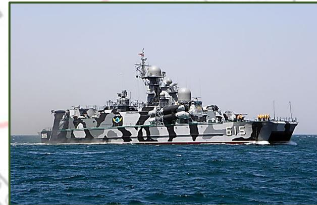
Ракетный корабль на воздушной подушке скегового типа проекта 1239
