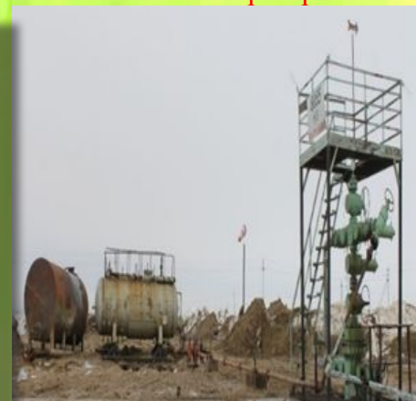
Отработка скважины через газовый сепаратор.
