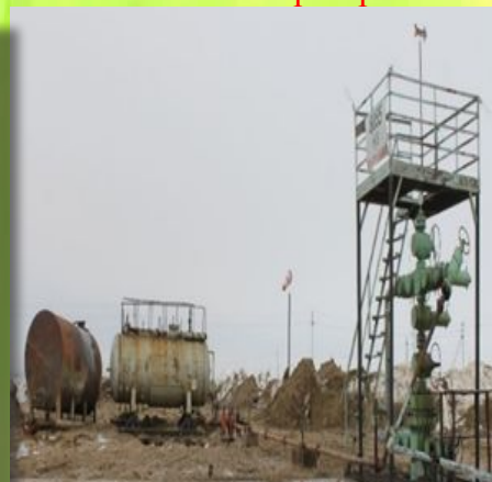
Отработка скважины через газовый сепаратор.
