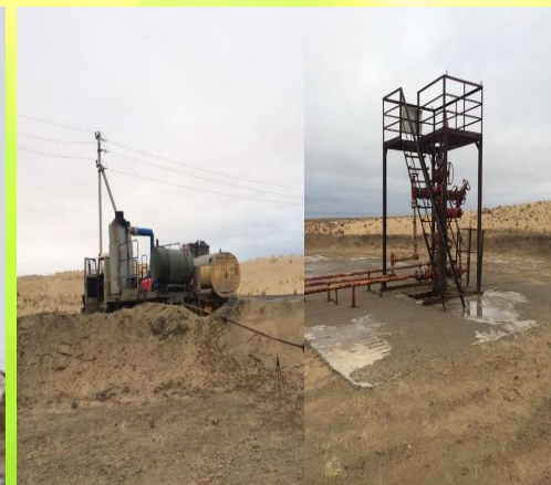
Горячая промывка выкидных линии скважины.
