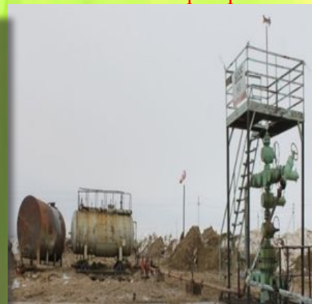
Отработка скважины через газовый сепаратор.
