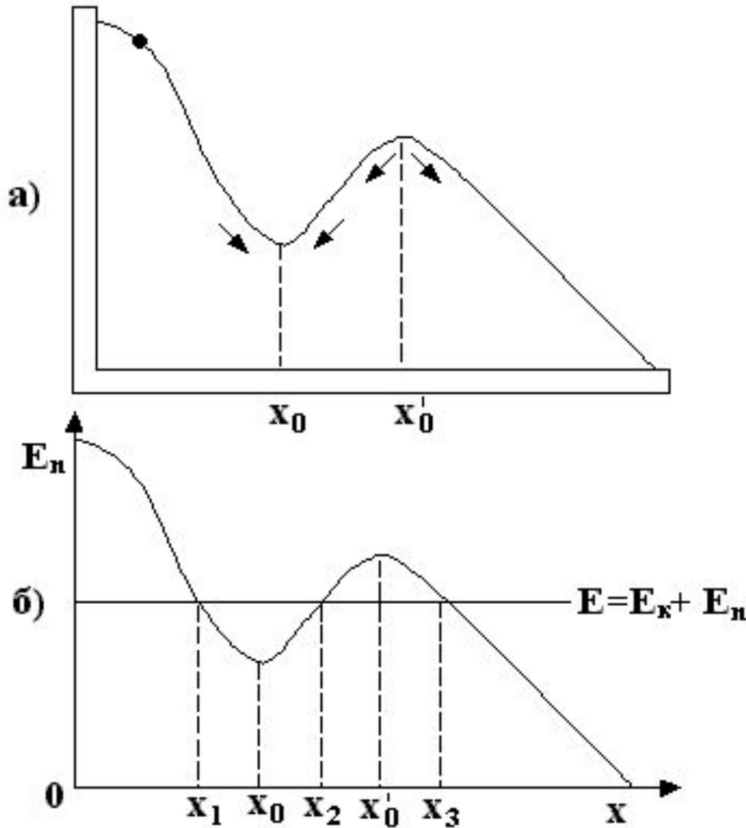
В качестве примера рассмотрим шарик, скользящий без трения по изогнутой в вертикальной плоскости проволоке.
