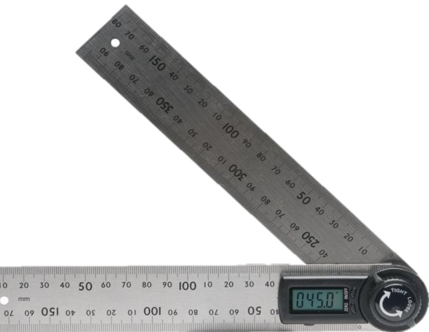
**Угломер - угломерный прибор, предназначенный для измерения геометрических углов в различных конструкциях, в деталях и между поверхностями, и между удалёнными объектами. Измерение производится в градусах, на основе линейчатой шкалы, линейчато-круговой шкалы, нониуса или в электронном виде, в зависимости от типа прибора.**
