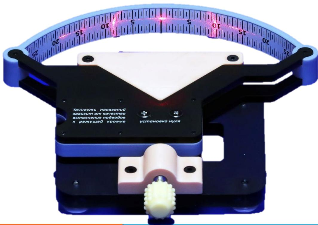
Замер угла лазерным угломером основан на образовании пространственной картины измеряемых деталей, где можно видеть опорные точки с координатами, измеренными лазерным дальномером.
