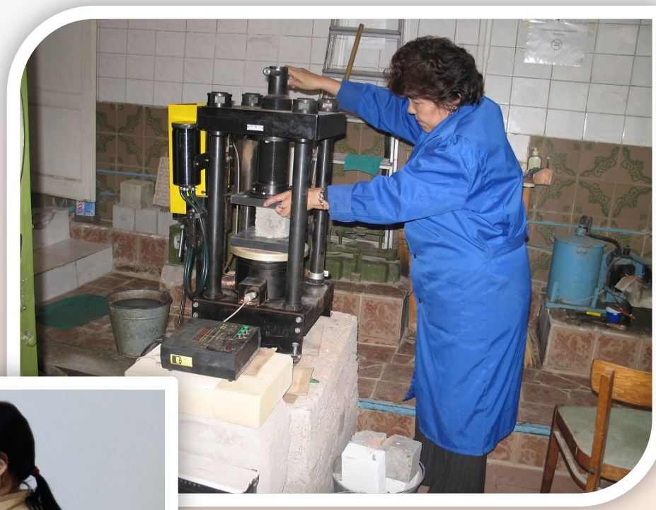
Испытание нового состава на прочность
