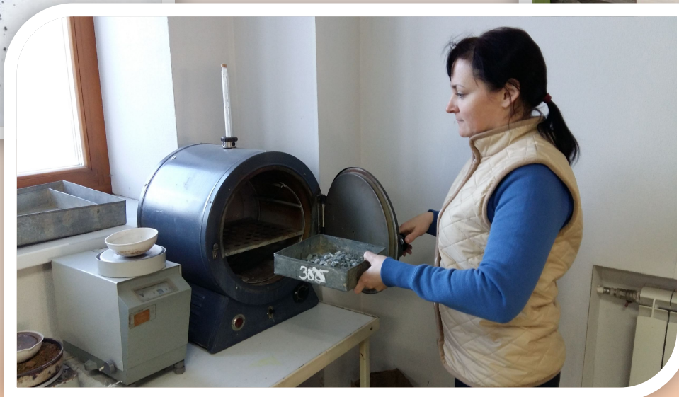
Влажный щебень ставят в сушку перед испытанием
