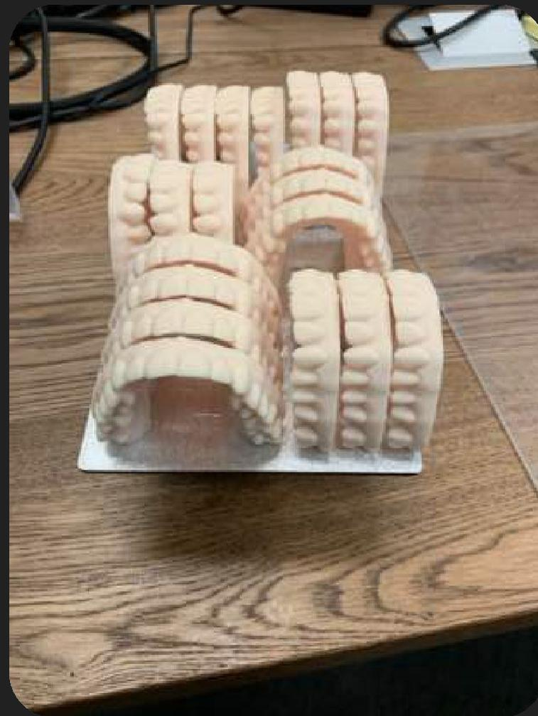
20 Vertikalmodelle in **1 Stunde und 9 Minuten** gedruckt
