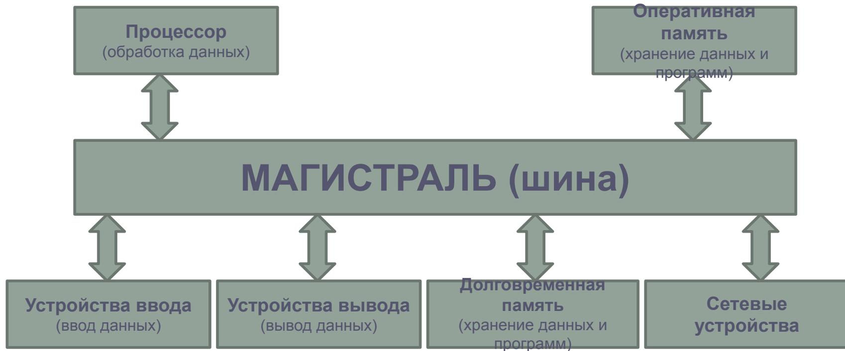
В основу архитектуры современных ПК положен магистрально-модульный принцип
