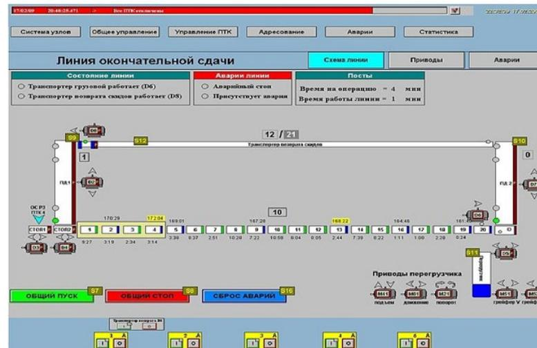
Рисунок 1.2 – Проект, созданный в системе SIMATIC WinCC
