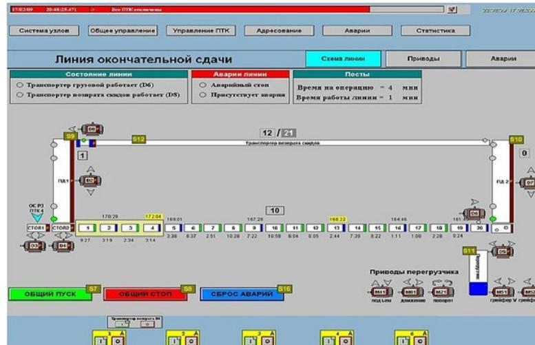
Рисунок 2 – Проект, созданный в системе SIMATIC WinCC
