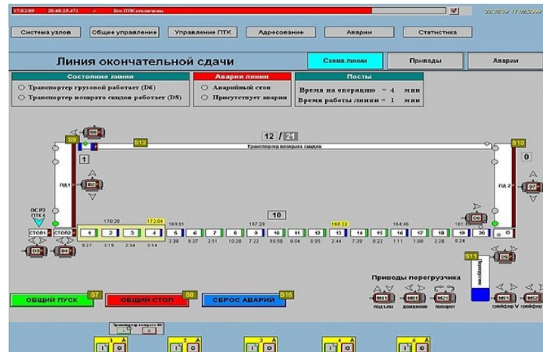
Рисунок 2 – Проект, созданный в системе SIMATIC WinCC
