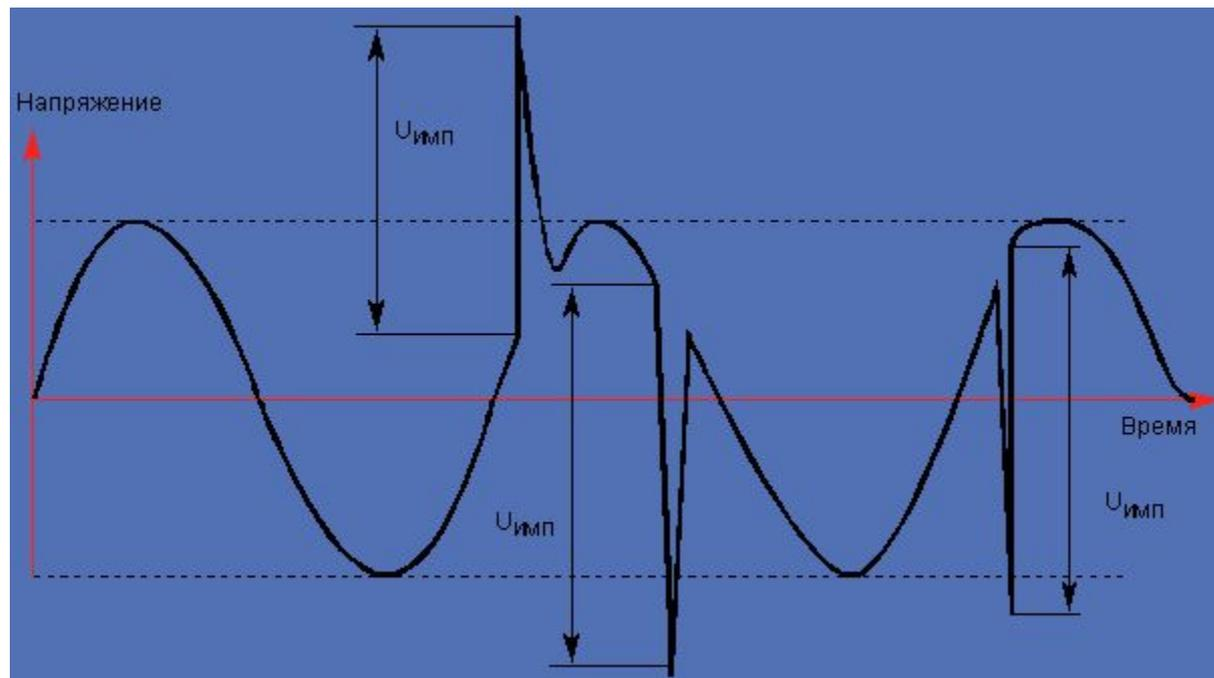
Рисунок 3. Импульсы напряжения.
