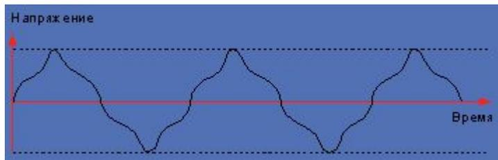
Рисунок 2. Несинусоидальное напряжение.
