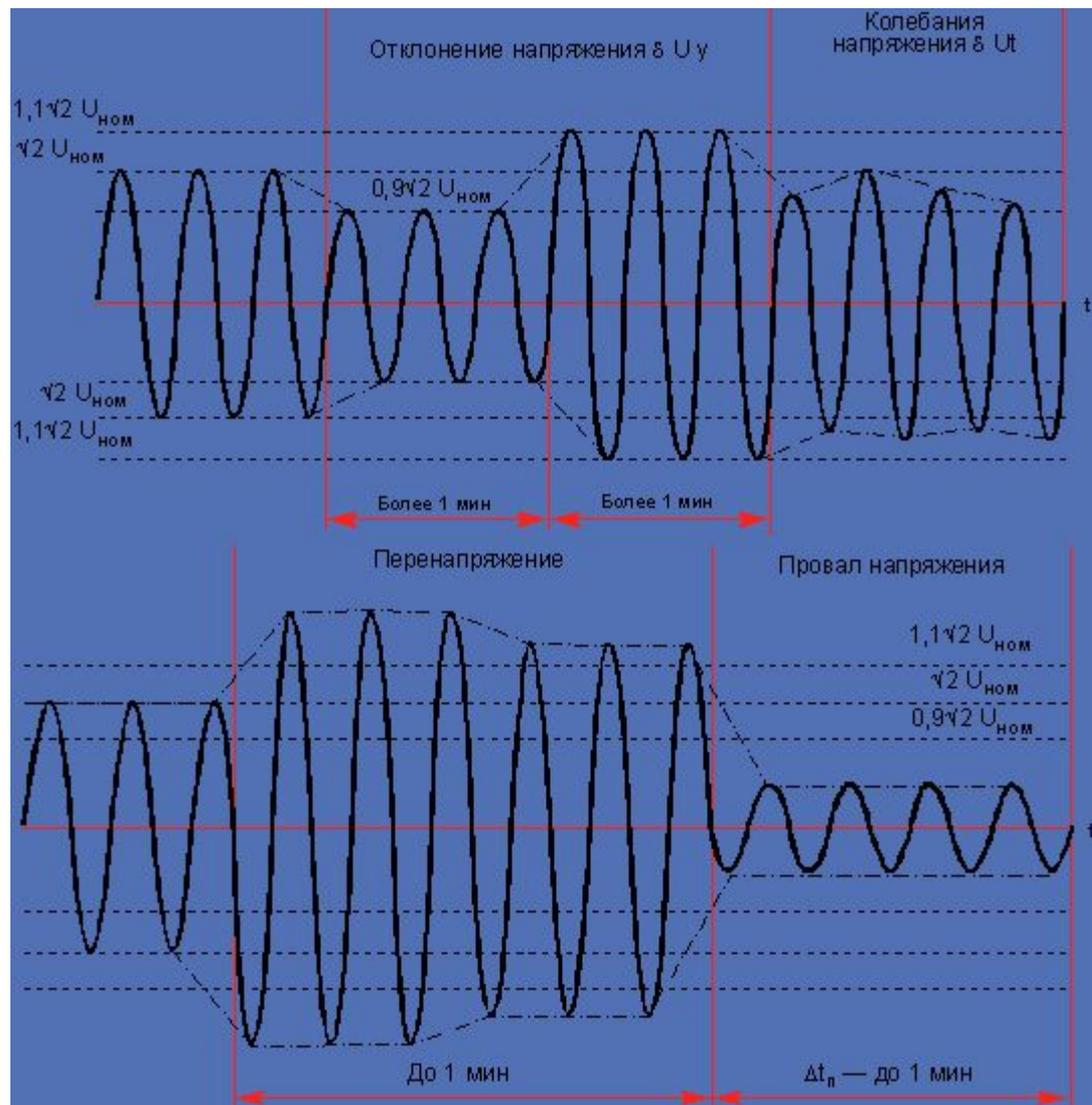
Рисунок 1. Отклонение, колебание, перенапряжение и провал напряжения.
