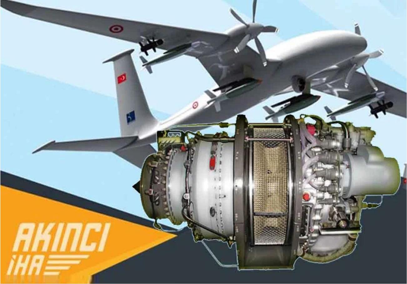
Они очень рассчитывали для своего нового БПЛА на украинский двигатель АИ-450Т, разработанный «Запорожским машиностроительным конструкторским бюро „Прогресс“ имени академика А. Г. Ивченко» в 1988 г. (на это старье огромный спрос!), но теперь завод "Мотор Сич" не сможет их обеспечить желанным двигателем
