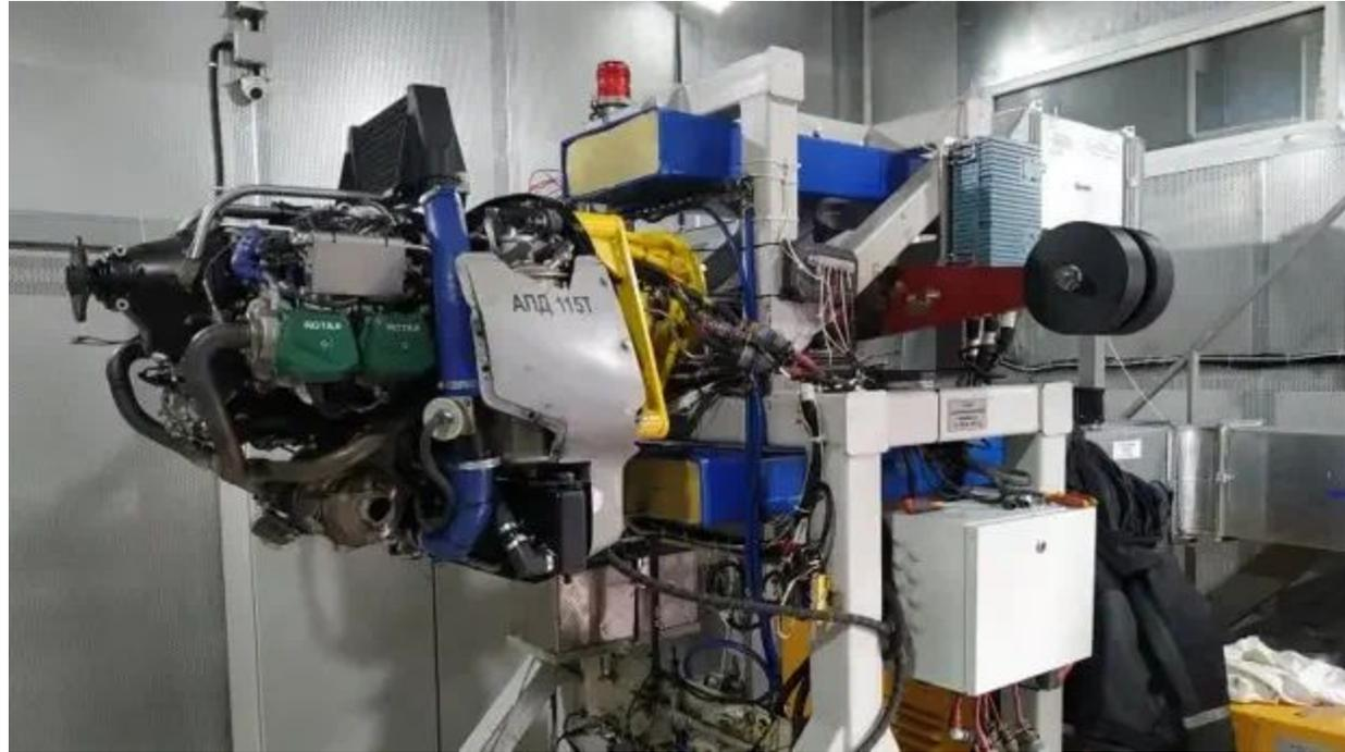
Инженерный центр "Итлан" в Рыбинске подключился к теме в 2013 г., и построил 17 двигателей. Их создали взамен использовавшемуся на "Орионе" изначально австрийскому Rotax 914 мощностью 86 кВт (115 л. с.) с турбокомпрессором для повышения высотности
