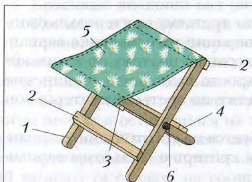
Рис. 78. Проектное изделие «стульчик»: 1 – ножка; 2 – планка наружной рамки; 3 – верхняя планка внутренней рамки; 4 – нижняя планка внутренней рамки; 5 – сиденье; 6 – крепёжные болты
