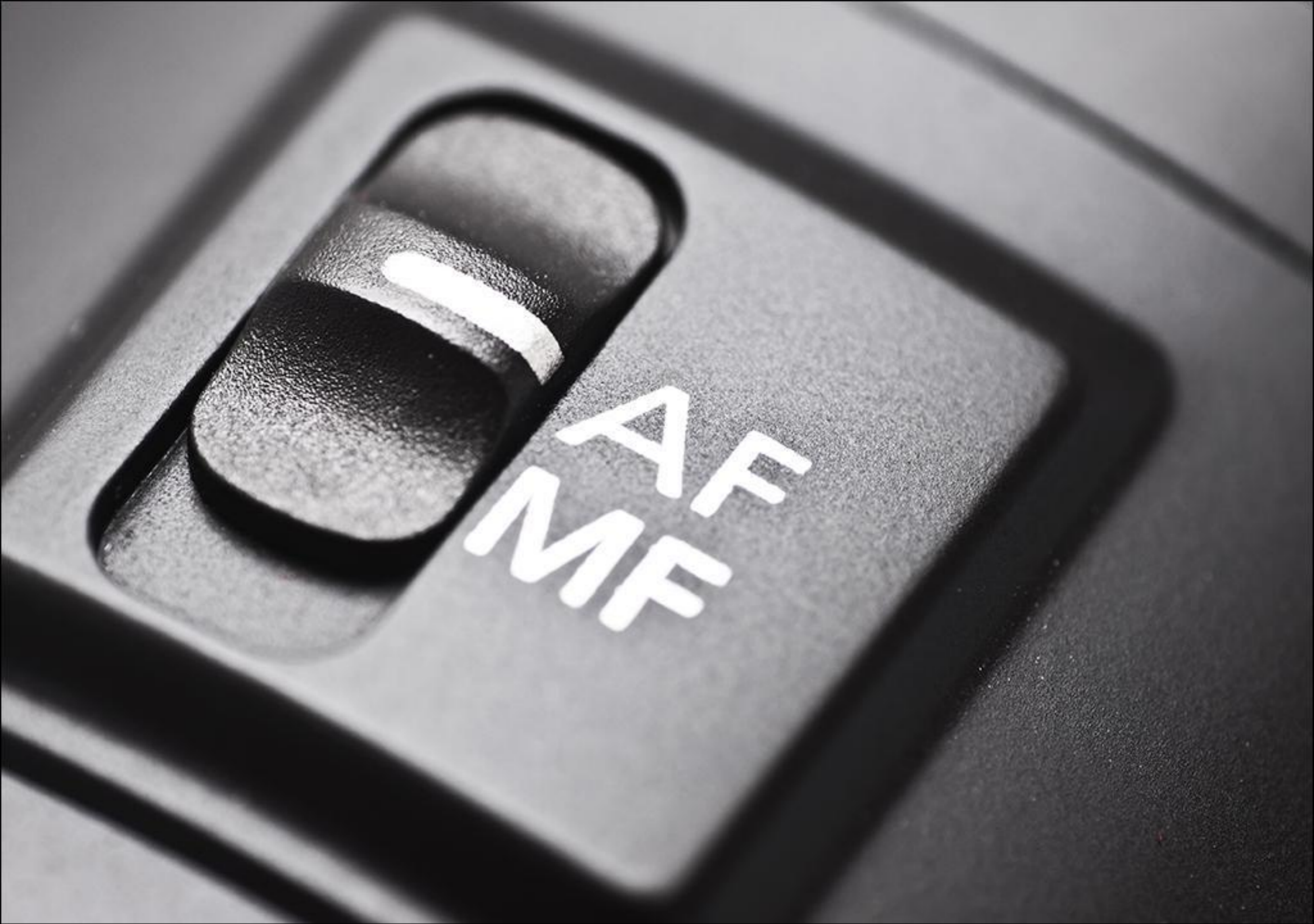
Переключатель А/М (автоматический/ручной фокус) на объективе
