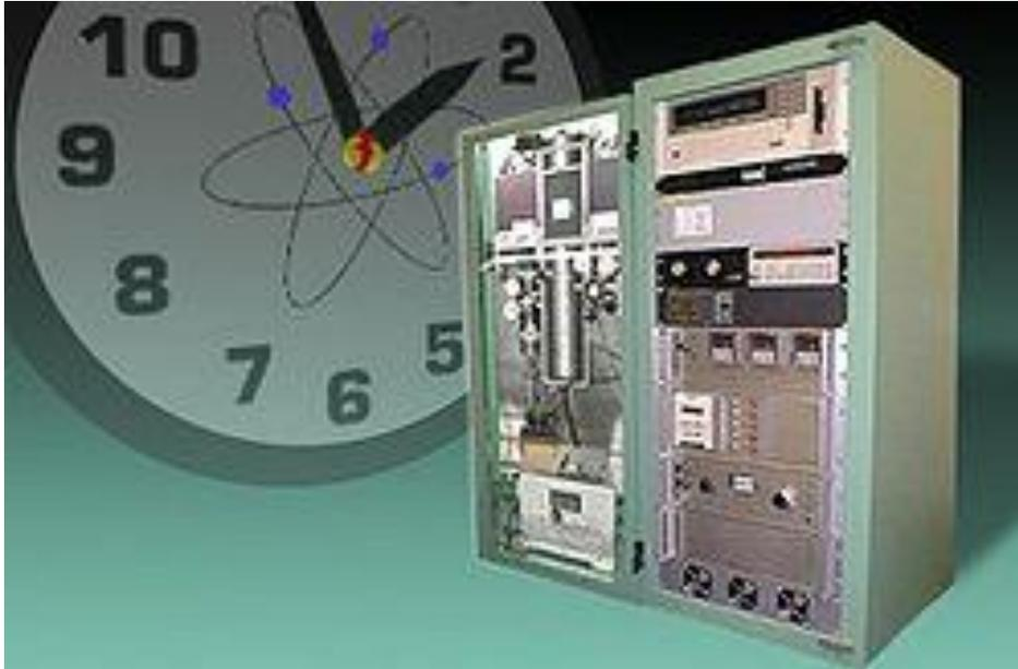
**Атомные часы** (молекулярные, квантовые часы) — прибор для измерения времени, в котором в качестве периодического процесса используются собственные колебания атомов или молекул.
