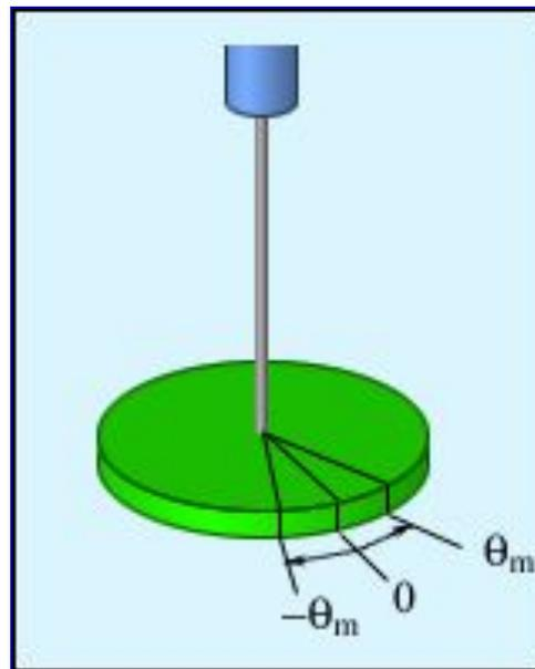
**4. Крутильный маятник широко используется в механических часах. Его называют балансиrom. В балансири момент упругих сил создается с помощью спиралевидной пружинки.**
