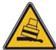
364 Осторожно. Возможность опрокидывания
