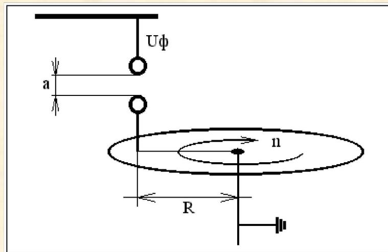
Схема искрового промежутка, моделирующего перемежающуюся дугу
