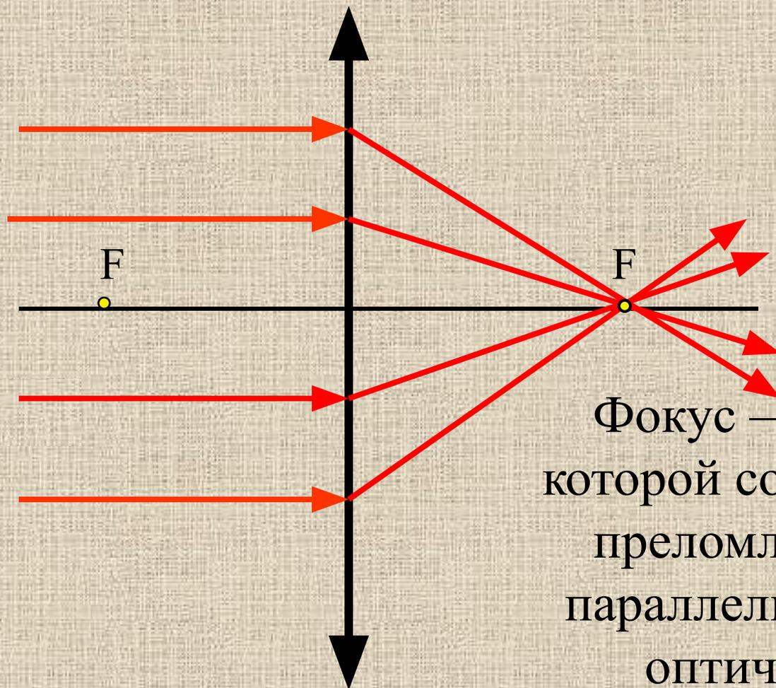
Фокус – это точка, в которой соберется после преломления пучок, параллельный главной оптической оси
