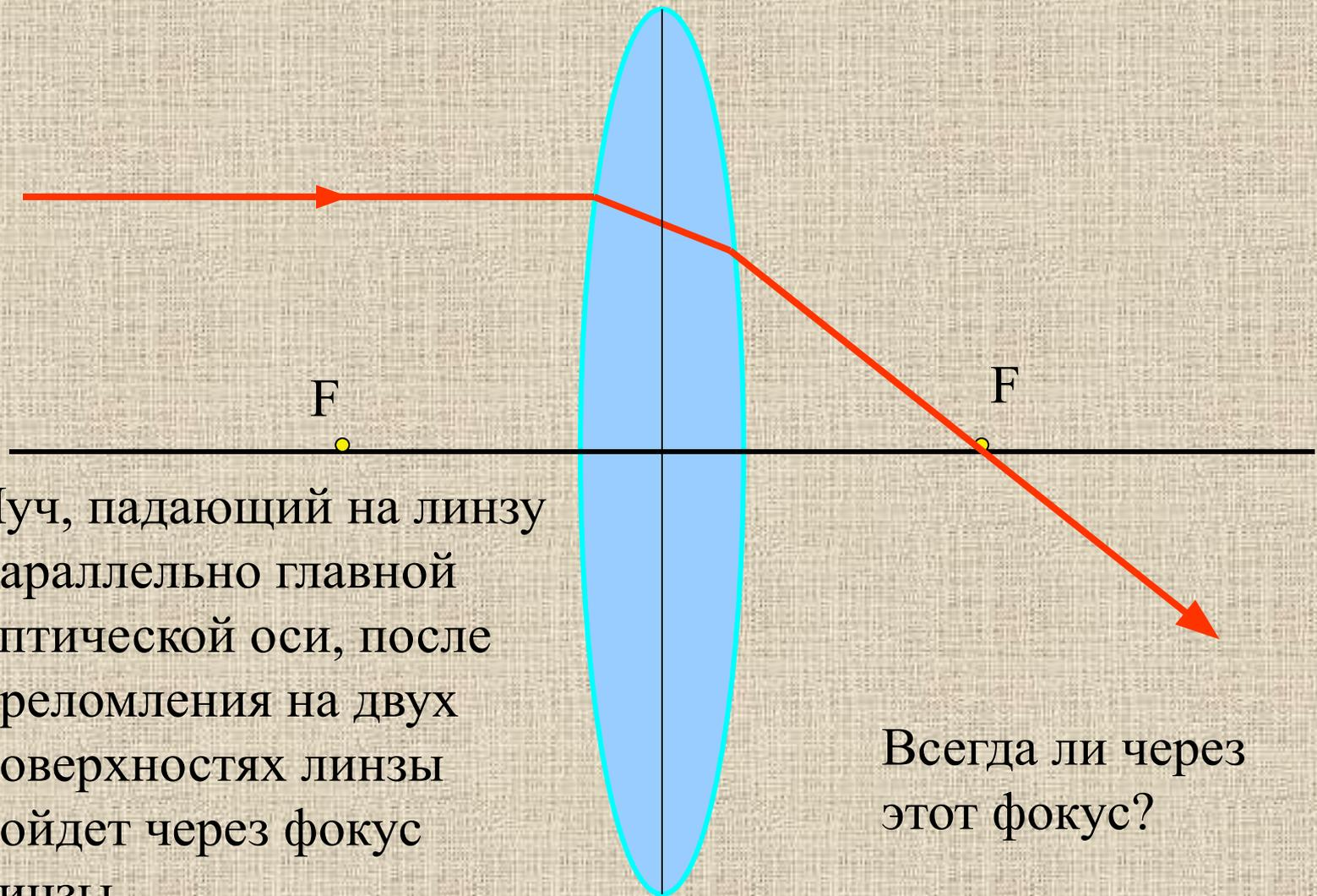
Луч, падающий на линзу параллельно главной оптической оси, после преломления на двух поверхностях линзы пойдет через фокус линзы
