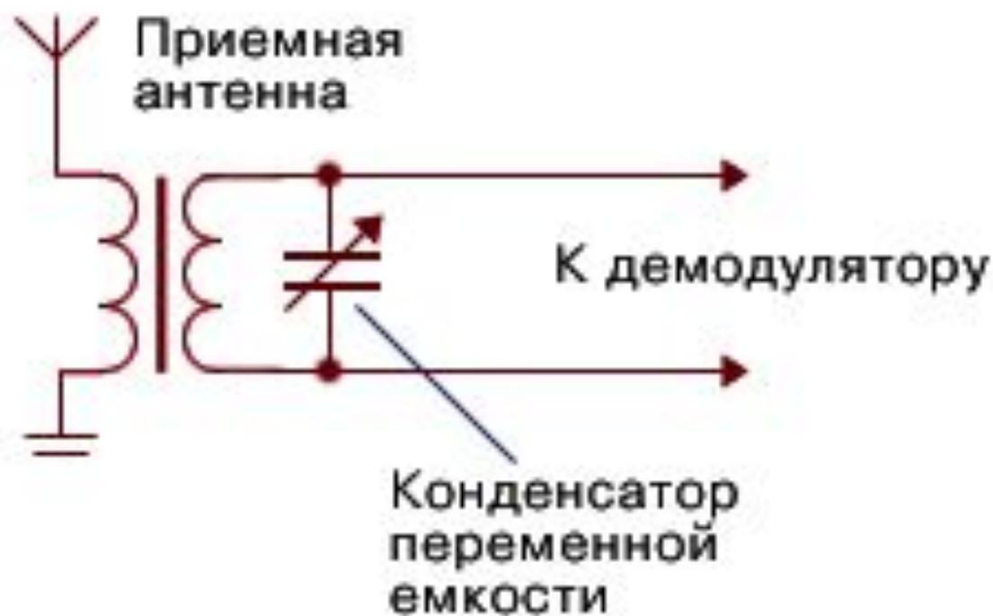
Настройка радиоприемника на разные несущие частоты осуществляется при изменении емкости конденсатора.
