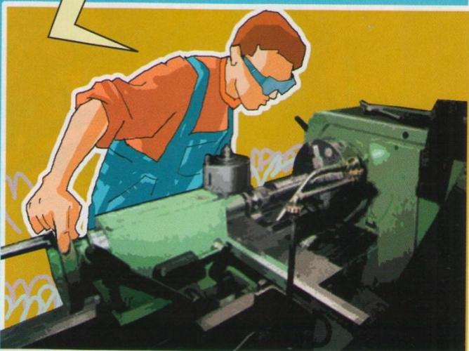
Заготовка на станке вращается,
