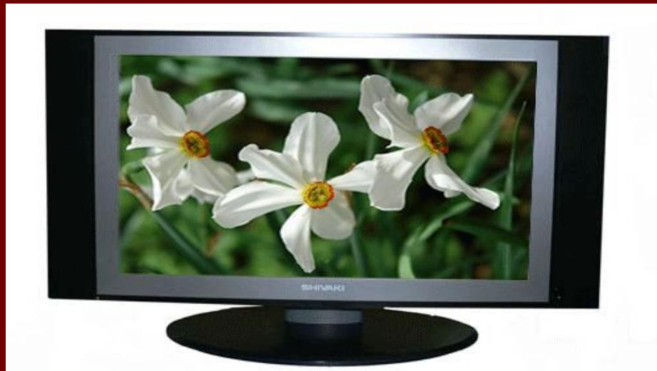
Но его свечение вызывается не электронами, а ультрафиолетовым излучением от газового разряда, возникающего в среде. . Плазменный экран представляет собой очень сложную конструкцию. Каждая его точка представляет собой отдельную изолированную ячейку, наполненную
