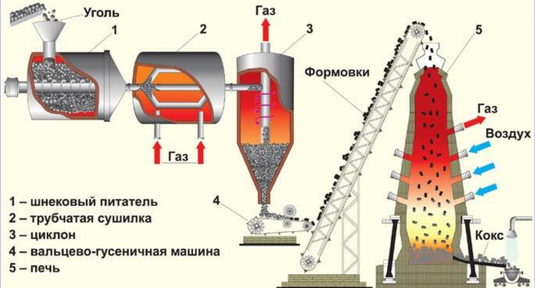
СХЕМА НЕПРЕРЫВНОГО КОКСОВАНИЯ УГЛЯ
