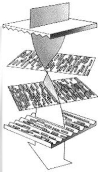
Принцип работы на Экраны LCD-мониторах (Liquid Crystal Display, жидкокристаллических мониторах)
