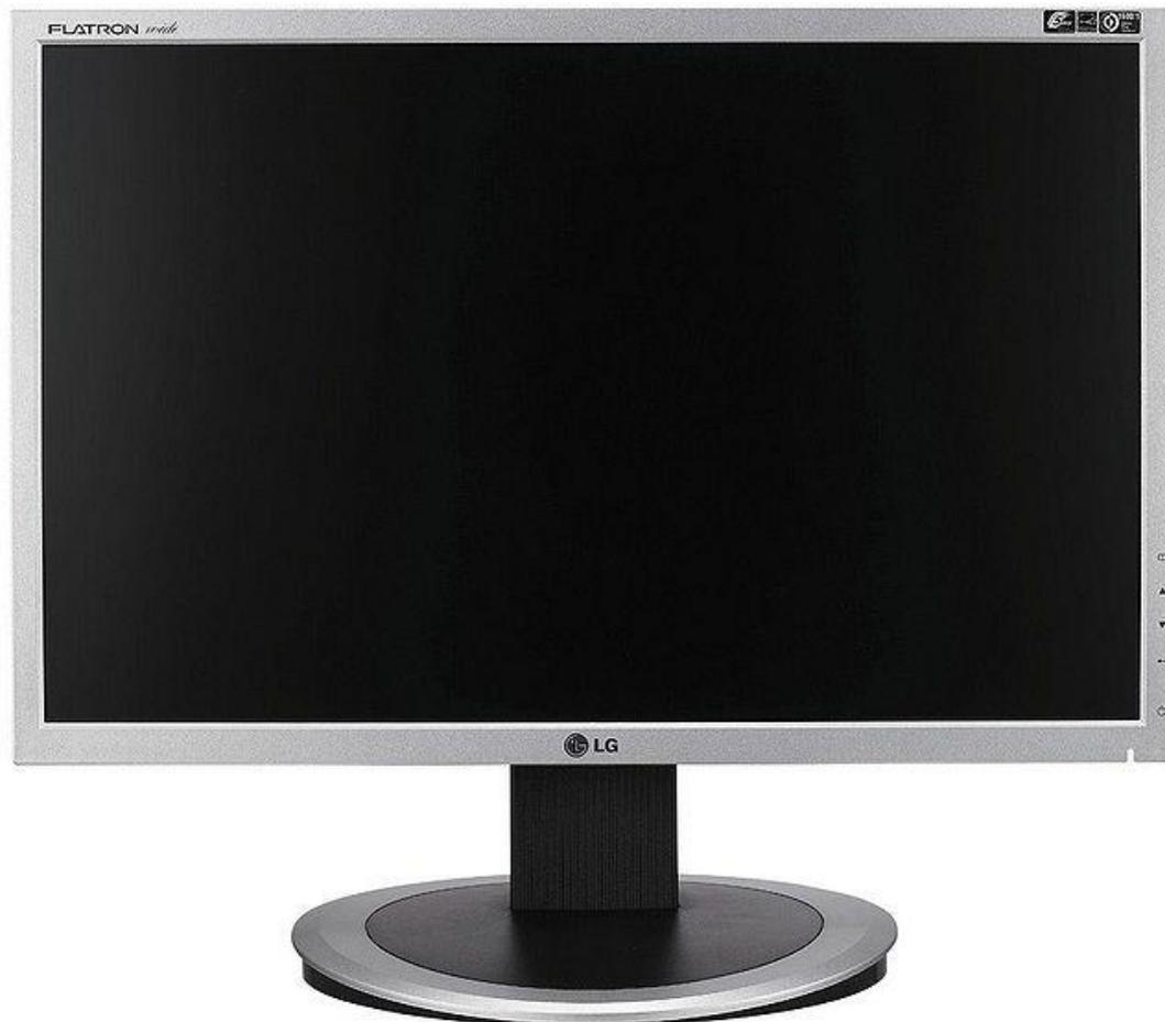
ЖК монитор – плоский дисплей на основе жидких кристаллов, а также монитор на основе такого дисплея.
