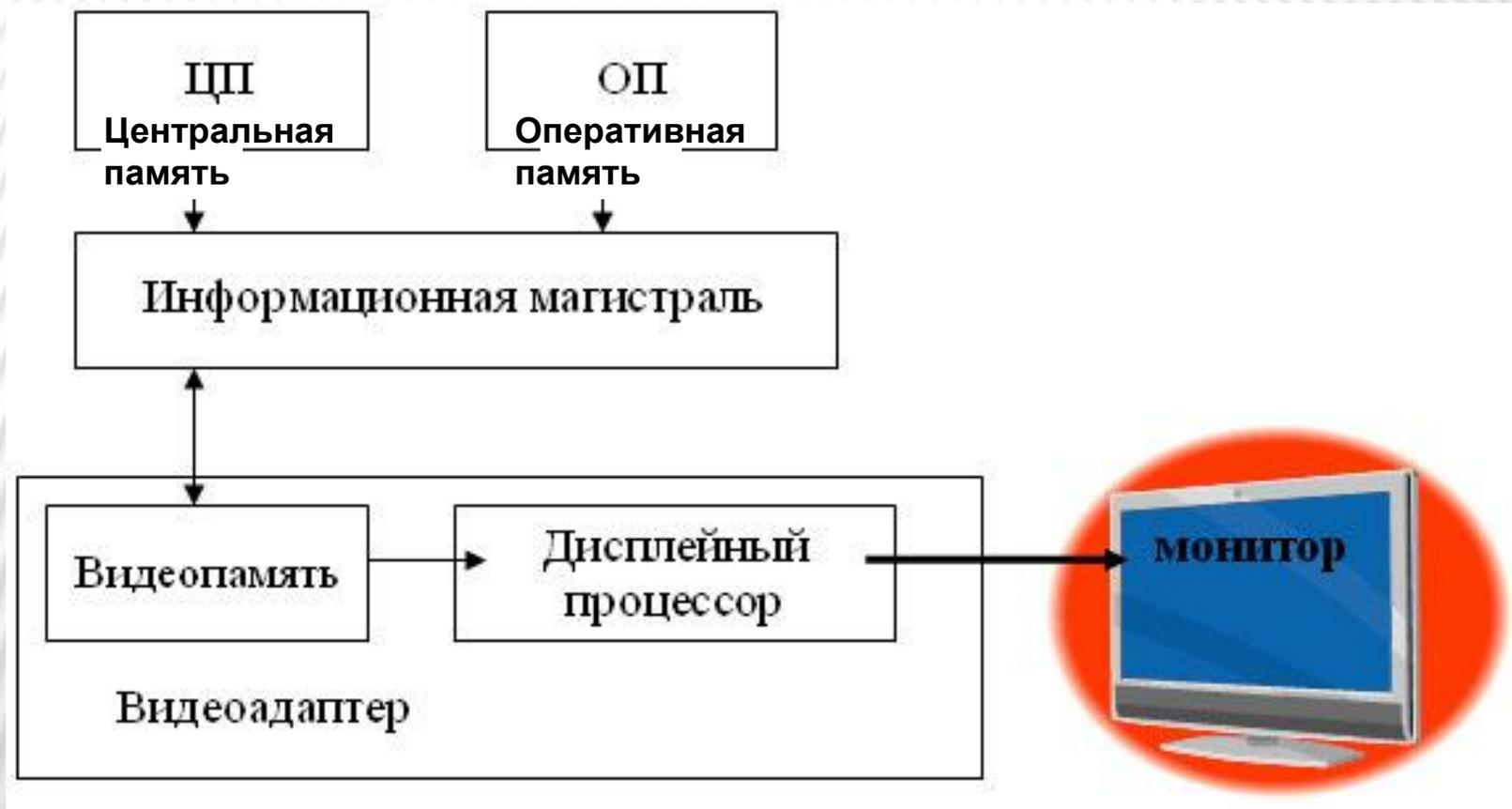
Практически все современные видеокарты принадлежат к комбинированным устройствам и помимо своей главной функции - формирования сигналов, в соответствии с которыми монитор может отображать ту или иную информацию на экран, - осуществляют ускорение выполнения графических операций. Такие устройства называются **видеоадаптерами** (*видеоконтроллерами*).
