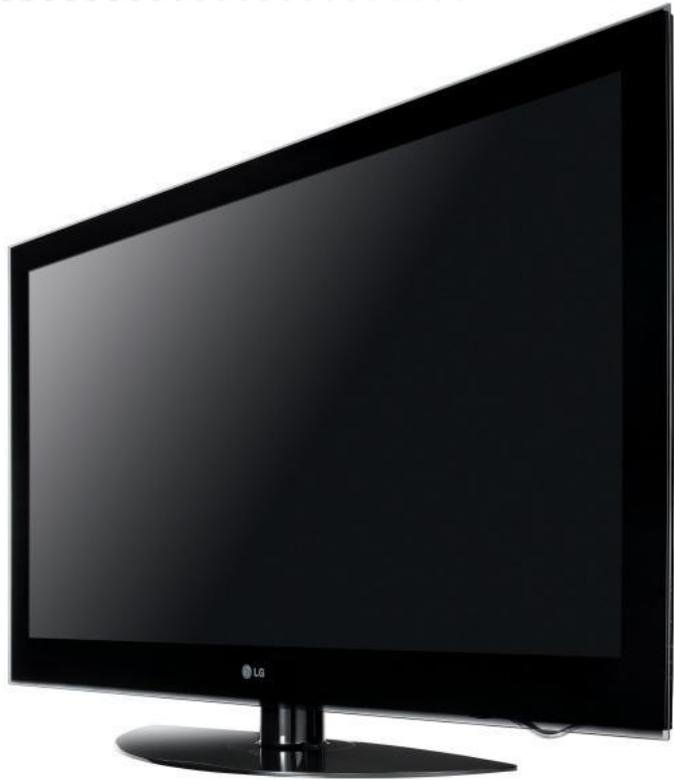
Плазменная панель – устройство отображения информации, монитор, основанный на явлении свечения люминофора под воздействием ультрафиолетовых лучей, возникающих при электрическом разряде в ионизированном газе, иначе говоря в плазме.
