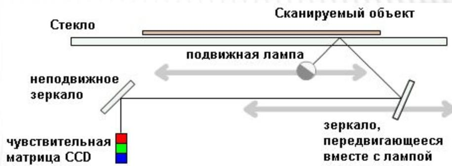
**Сканер** – устройство, которое, анализируя какой-либо объект, создаёт цифровую копию изображения объекта. Процесс получения этой копии называется *сканированием*.
