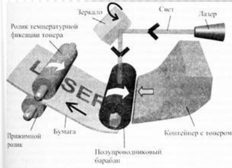
Когда луч лазера попадает на предварительно заряженный барабан, заряд "стекает" с освещенной поверхности.
