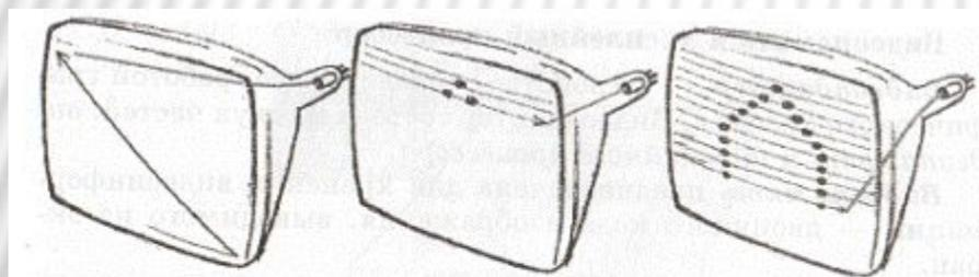
Рис. 4.9. Получение растрового изображения в электронно-лучевой трубке
