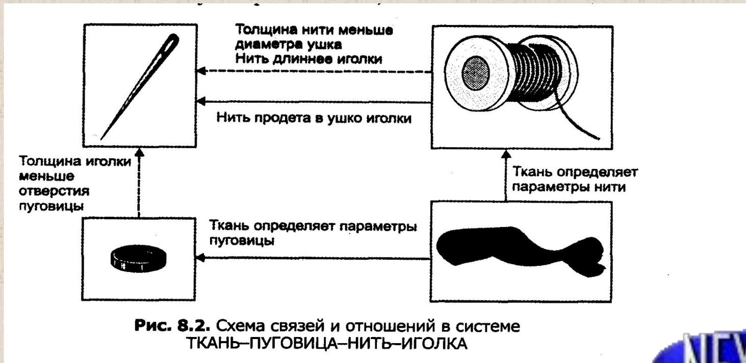
Рис. 8.2. Схема связей и отношений в системе ТКАНЬ–ПУГОВИЦА–НИТЬ–ИГОЛКА
