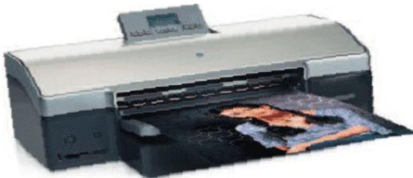
Струйные принтеры относятся к безударным печатающим устройствам. Данные устройства работают практически бесшумно. Струйные чернильные принтеры относятся к классу последовательных матричных безударных печатающих устройств. Они же в свою очередь подразделяются на устройства непрерывного и дискретного действия. Последние же могут использовать либо пузырьковую технологию, либо пьезоэффект.
