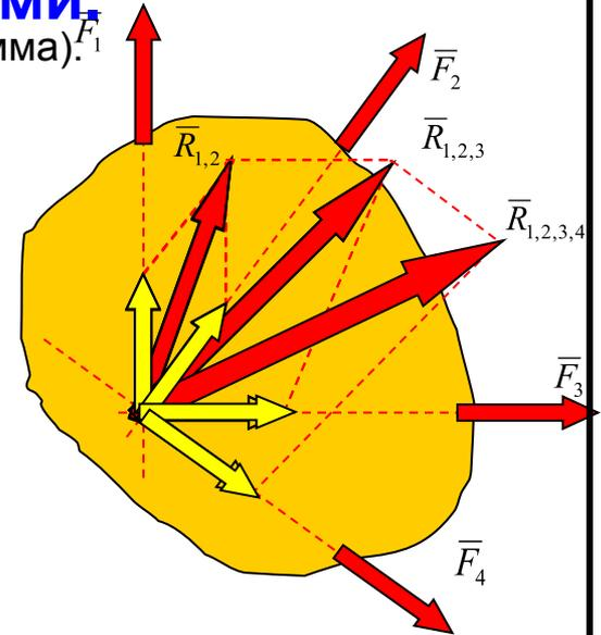
Сложение сил построением параллелограммов можно заменить построением силового треугольника – выбирается одна из сил или изображается параллельно самой себе с началом в любой произвольной точке, все другие силы изображаются параллельными самим себе с началом, совпадающим с концом предыдущей силы.
