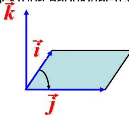
Определение. Упорядоченная тройка ортов  $\vec{i}, \vec{j}, \vec{k}$  называется *левой*, если при совмещении начал векторов кратчайший поворот первого вектора ко второму с конца третьего вектора наблюдается по часовой стрелки.
