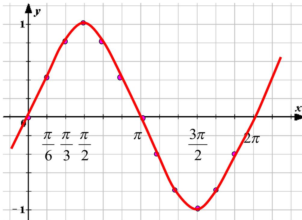
*График функции  $y = \cos x$  получается переносом графика функции  $y = \sin x$  влево на  $\pi/2$ .*
