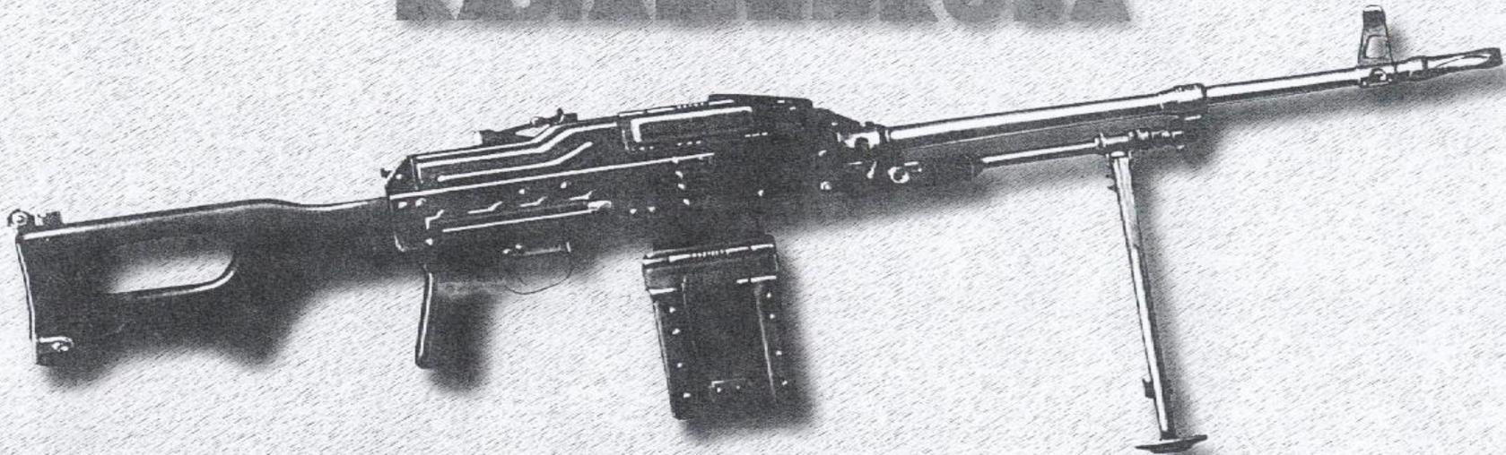
**Н**а вооружении войск 7,62-мм единый пулемет Калашникова начал поступать в начале 60-х годов. В 1986 г. он прошел модернизацию и стал обозначаться ПКМ. Пулемет неприхотлив в эксплуатации, прост в изготовлении.
