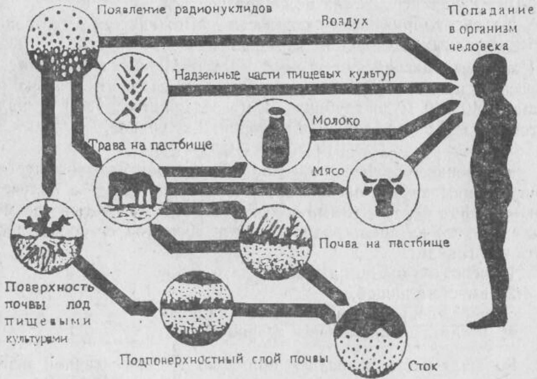
Рис. 9. Распространение радиоактивных веществ в окружающей среде
