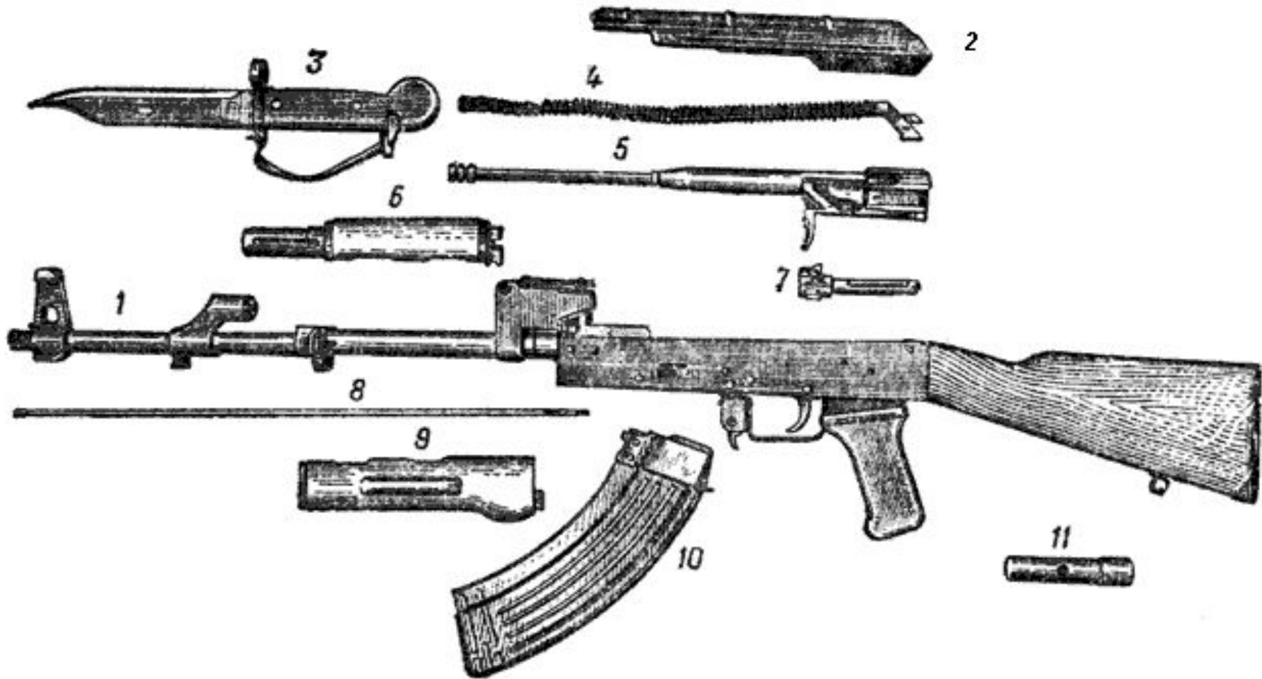
Рис. 2. Основные части и механизмы автомата:
