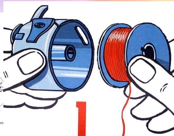
2. Протяните нить правой рукой через косую прорезь под прижимную пружину, а затем в небольшую прорезь на конце пружины.
