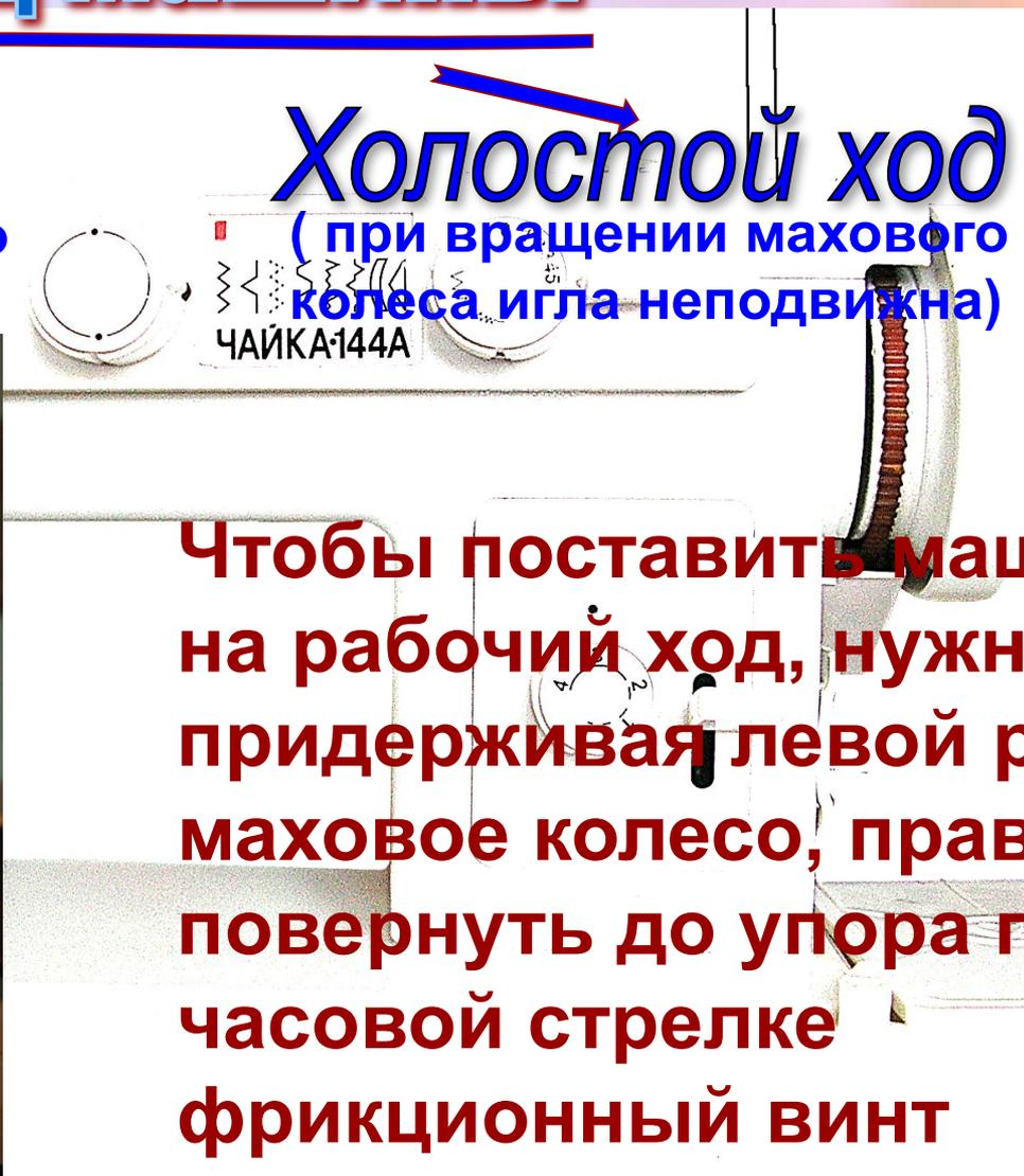
Чтобы поставить машину на рабочий ход, нужно придерживая левой рукой маховое колесо, правой повернуть до упора по часовой стрелке фрикционный винт
