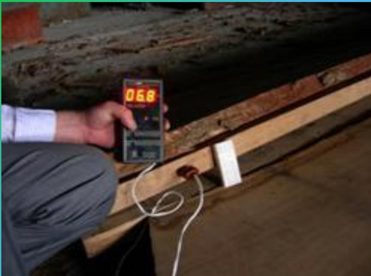
**Определение влажности с помощью прибора**
